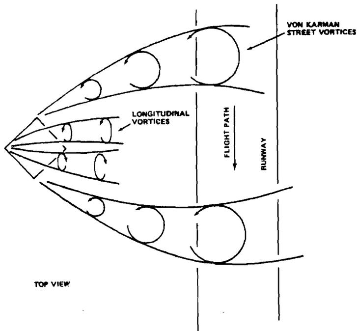
FIGURE 20. CROSSWIND FLIGHT PATHS THROUGH VORTICES
