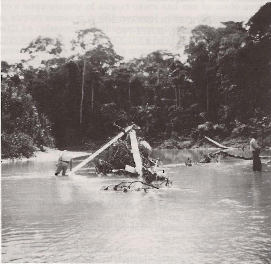
El núcleo del rotor principal se rompió dando como resultado que las palas rotaran en posición de aproximadamente 60 grados de su posición normal, las que destrozaron las ramas del árbol y la cabina del helicóptero, lesionando mortalmente al piloto.
