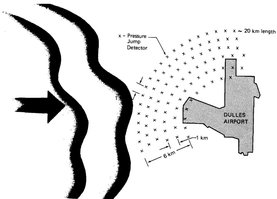
FIGURE 10. LOCATION OF PRESSURE JUMP DETECTORS AROUND DULLES
